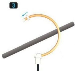
3 打开接头，穿过电缆
